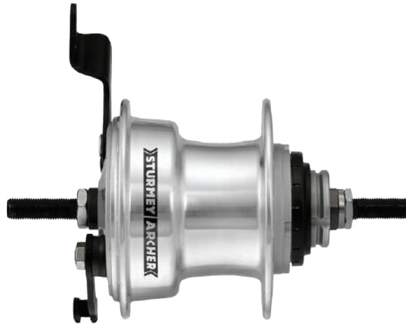
RX-RD3 · 3- Speed · 70mm Drum Brake Hub
